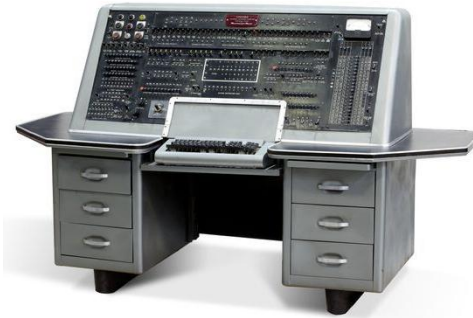
ภาพที่ 1.5 UNIVAC คอมพิวเตอร์อิเล็กทรอนิกส์เพื่อการคำนวณเครื่องแรกของโลก ที่มา https://www.computerhistory.org/revolution/early-computer-companies/5/100
